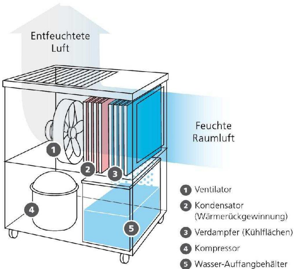
Die feuchte Luft wird von einem Ventilator angesaugt und durch einen Kühlteil (Verdampfer) geleitet. Durch die schnelle Abkühlung kondensiert die Luft am Verdampfer und wird als Wassertropfen ausgeschieden. Das Kondenswasser wird im Behälter gesammelt oder kann über eine Schlauchleitung abgeführt werden. Alle integrierten Behälter sind überlaufgesichert.
