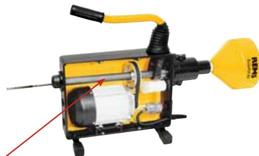
Durchgehende, geschlossene Antriebsspindel schützt Motor und Antrieb vor Schmutz und Wasser.
