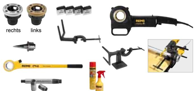
Leistungsstarkes, handliches Elektrowerkzeug zum Gewindegewindeschneiden mit einzigartigem Abstützbügel. Ohne Schraubstock überall einsetzbar. Ideal für Reparatur, Renovierung, Baustelle.
