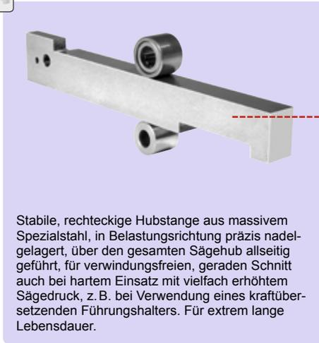
Stabile, rechteckige Hubstange aus massivem Spezialstahl, in Belastungsrichtung präzise nadelgelagert, über den gesamten Sägehub allseitig geführt, für verwindungsfreien, geraden Schnitt auch bei hartem Einsatz mit vielfach erhöhtem Sägegedruck, z. B. bei Verwendung eines kraftübersetzenden Führungshalters. Für extrem lange Lebensdauer.
