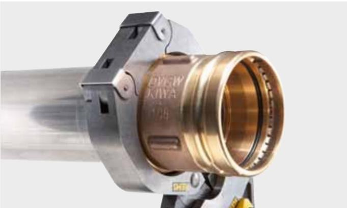
REMS Pressring (PR-3B) mit 3 Pressbacken für anspruchsvolle Pressungen großer Dimensionen. Optimale Pressung durch radial gesteuerte Bewegung der Pressbacken, mit Zwischenzange.
