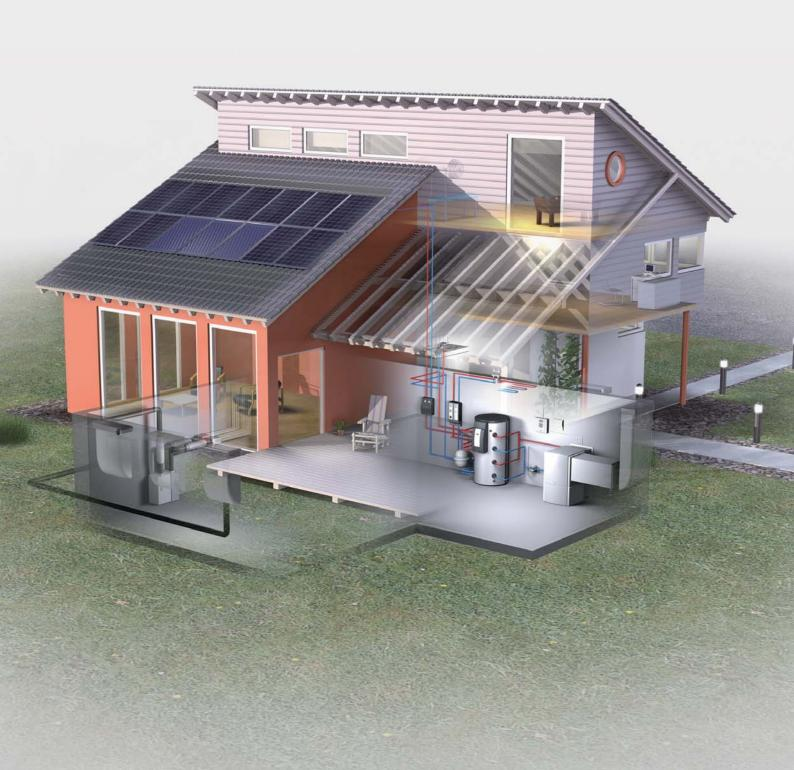
Wärmepumpe Schichtenspeicher BSP-W Solarkollektoren TopSon F3-1 Photovoltaikmodule Comfort-Wohnungs-Lüftung CWL
