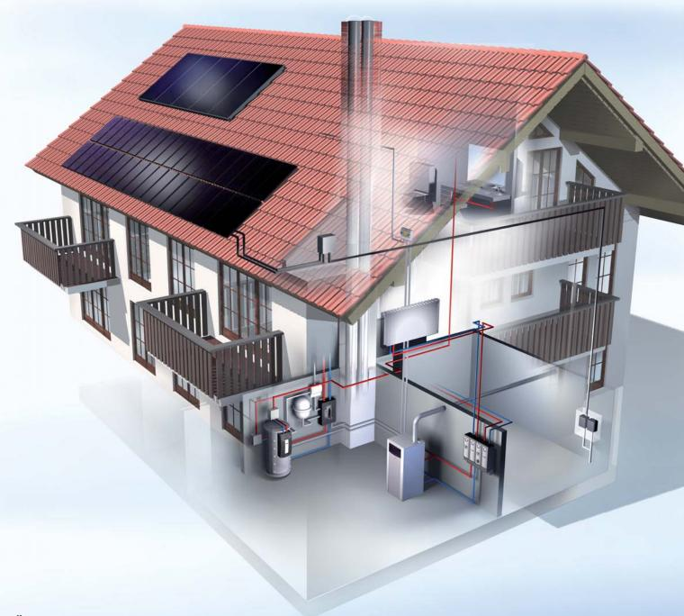
Ölbrennwertkessel COB Schichtenspeicher BSP Solarkollektoren TopSon F3-1 Photovoltaikmodule
